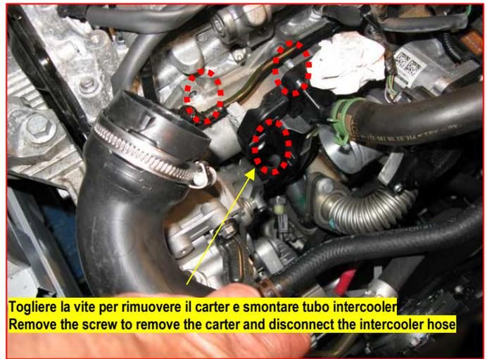
5. Allentare le viti che servono per lo spostamento del cablaggio, rimuovere il gancio per sollevamento motore ed eliminare le due viti originali (foto n. 3);
