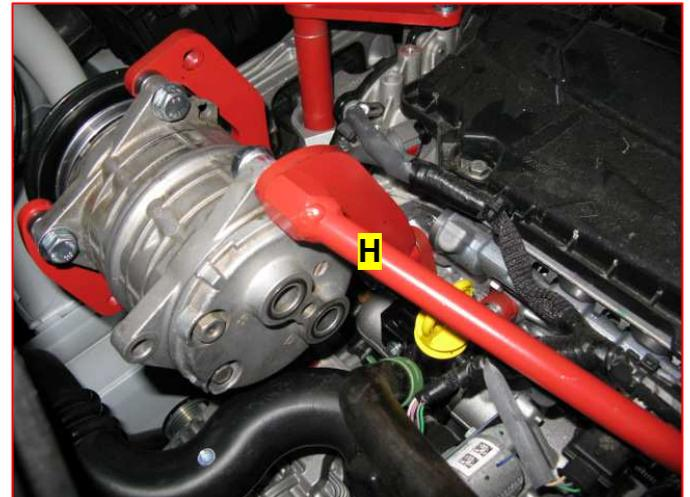
21. Bloccare tutte le viti che fissano il compressore e le staffe al motore;
