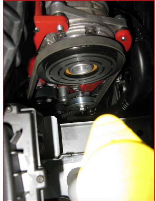
24. Ricollegare la batteria, avviare il motore per 15/20 minuti, verificare nuovamente il corretto tensionamento delle cinghie, la bulloneria ed eventuali interferenze.
