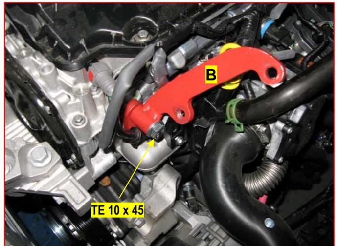
13. Montare il supporto "B" con la vite TE 10 x 45 x 1,5 + rondella, posizionandola senza bloccare (foto n. 10);
